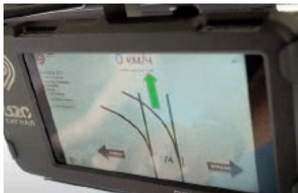
Рис. 3. Планшет для управления стрелкой и индикации ее состояния в кабине водителя трамвая
