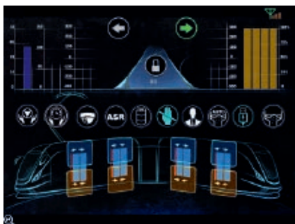
Рис. 4. Индикация состояния стрелочного перевода на экране в кабине водителя трамвая
