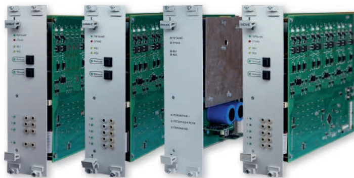
Платы объектных контроллеров МПЦ-СМ
