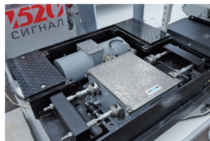
Электромагнитный трамвайный привод ЭМПТ-31К – часть системы АСКУ ДВТ
