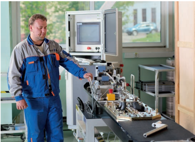
Тестирование шпального стрелочного электропривода в лаборатории
