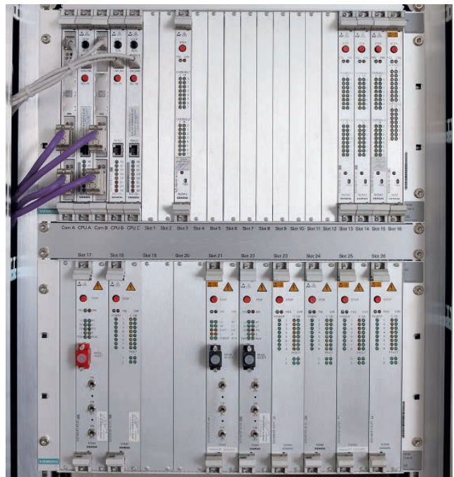
Вариант исполнения МПЦ-МЗ-Ф на импортной аппаратной платформе
