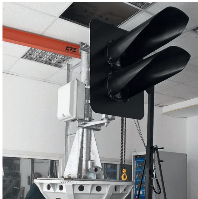
Испытания фрагмента светофора на вибростенде (вертикальная вибрация)
