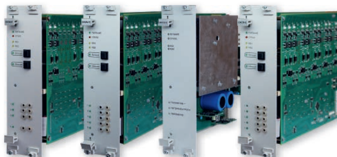
Платы объектных контроллеров МПЦ-СМ
