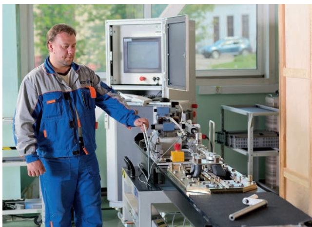
Тестирование шпального стрелочного электропривода в лаборатории
